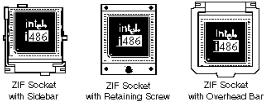
Fig. 2-2 Types of ZIF sockets
